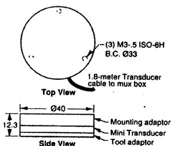
Figure 3. Dimensions of mini F/T sensors (in mm)
